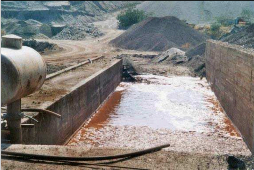
Obrázok 39. Odvodnenie kalu z úpravy barytu v betónových nádržiach [110, IGME, 2002]
