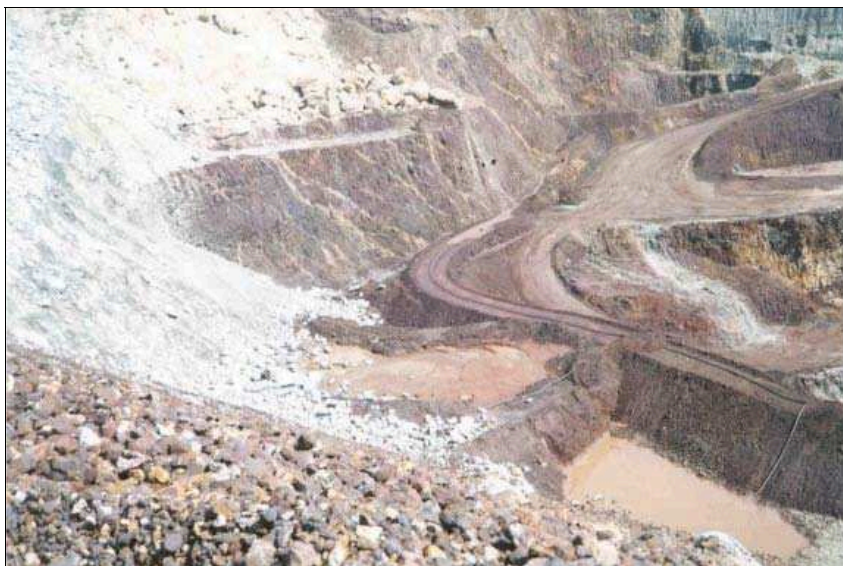
Obrázok 38. Odvodnenie kalu z úpravy barytu v povrchovej bani [110, IGME, 2002]
